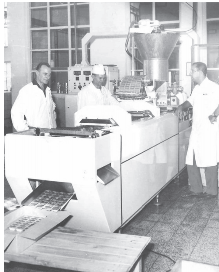
Poloaautomat BTK na plnění džemů a hořčice do jednoporcových misek z PVC
